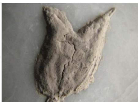
تصویر ۲۱. ترک‌ها بر سطح نقوش اجرا شده با نسبت سریش یک به پانزده (نگارندگان).
