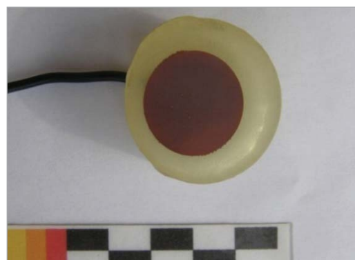
تصویر ۳. تفاوت در رنگ کوپریت قبل از غوطه‌وری در سیتريک اسيد به مدت يك ساعت (نگارندگان).
