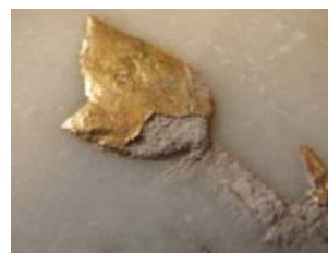
تصویر ۳۲. نمونه اجراشده در یک مرحله برای پیرسازی رطوبتی پس از پیرسازی (نگارندگان).
