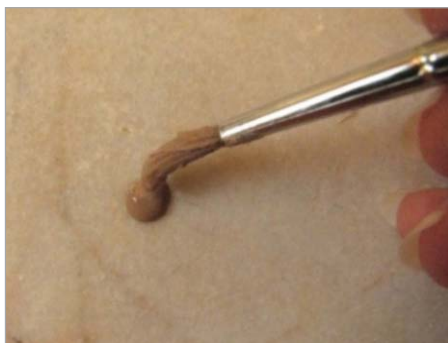
تصویر ۱۳. ترکیب لایه چینی با غلظت مناسب که بر سطح سنگ شوه نمی کند (نگارندگان).
