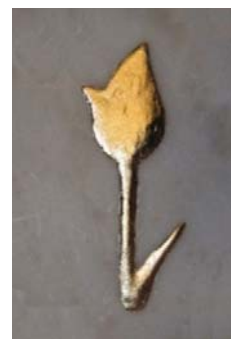
تصویر ۲۸. نمونه اجراشده در یک مرحله برای پیرسازی حرارتی (نگارندگان).
