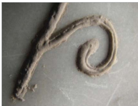
تصویر ۲۲. فرورفتگی‌ها بر سطح نقوش اجرا شده با نسبت سریش یک به پانزده (نگارندگان).
