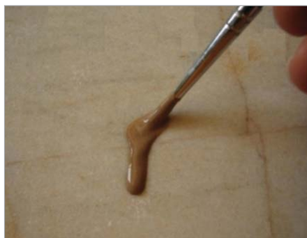
تصویر ۱۱. سرازیر شدن ترکیب لایه چینی بر سطح سنگ (نگارندگان).
