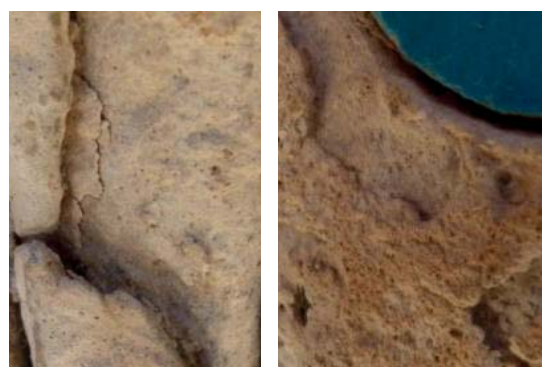
تصویرهای ۱۸-۱۹. پوسیدگی در سطح سنگ کتیبه (نگارندگان).
