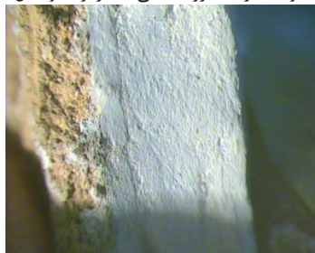
تصویر ۱۳. مقطع عرضی نمونه گچ‌بری حاشیه طاق‌نمای محراب شازده با بزرگ‌نمایی ۱۸ برابر (در تصویر لایه گچ واسط بین لایه تزئینی و بستر گچ و خاک کاملاً پیداست) (نگارندگان).
