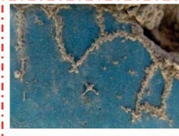
تصویر ۷. تبلور نمک در سطح ترک‌ها (نگارندگان).
