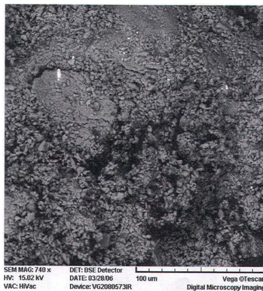
تصویر ۱۲. تصویر SEM نمونه 1/62. که هوازگی و تخلخل در سطح سنگ دیده می شود (نگارندگان).
