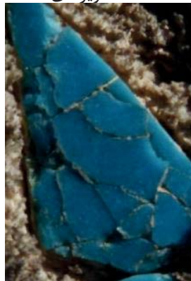
تصویر ۶. نفوذ رطوبت از طریق درزهای بین کاشی و ایجاد ترک در سطح لعاب بر اثر تنش بین لعاب و بدنه (نگارندگان).
