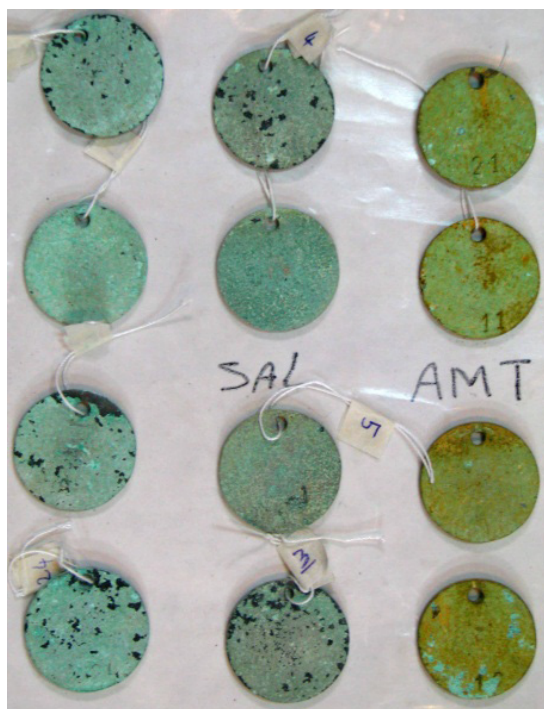
تصویر ۱. لایه پاتین (الف) قبل از درمان نمونه شاهد (ب) پس از غوطه وری در مریم گلی دارویی (ج) پس از غوطه وری در بازدارنده آمینومرکاپتو تیادیازول
