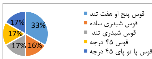
تصویر ۳۰. میزان نسبت طول، عرض، ارتفاع پل‌های صفویه گیلان (نگارندگان، ۱۴۰۰) تصویر ۳۱. انواع قوس به کاررفته در پل‌های صفویه گیلان (همان)
