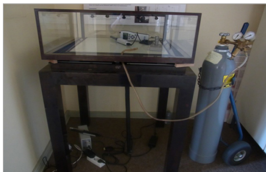
تصویر ۲. اندازه‌گیری سرعت تبادل هوا با روش ردیابی گاز CO 2 (نگارندگان)
