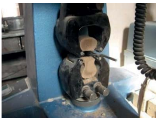
تصویر ۶. نمونه‌ها پاپیونی تحت آزمایش مقاومت کششی
