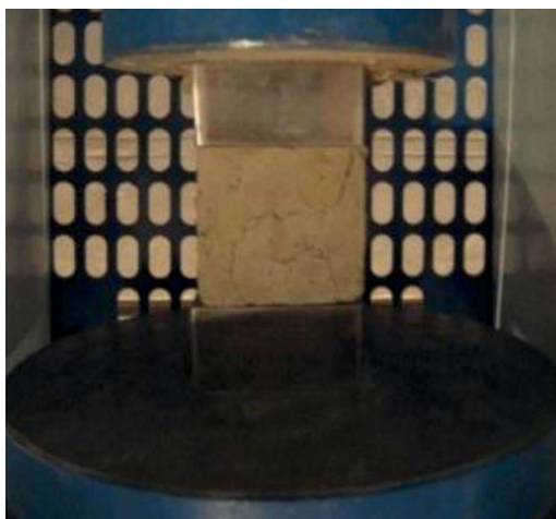
تصویر ۵. آزمایش مقاومت فشاری نمونه‌ها
