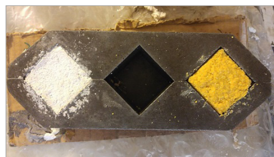
شکل ۴. نمونه‌های ساخته شده با زرده و سفیده تخم‌مرغ در قالب نمونه (نگارندگان)
