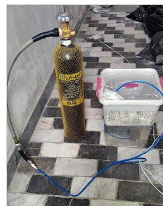
شکل ۱. محفظه CO_2 دهی (نگارندگان) شکل ۲. استفاده از ماسک و دستکش و لباس مناسب (همان) شکل ۳. نمونه های ۳ روزه در آب (همان)
