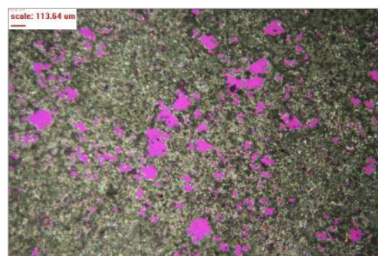
تصویرهای ۲۱-۲۲. وجود تخلخل زیاد در سنگ‌های کتیبه با بزرگ‌نمایی (40X) (نگارندگان).
