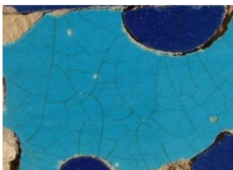
تصویر ۵. وجود ترک شاخه‌ای در سطح لعاب کتیبه (نگارندگان).
