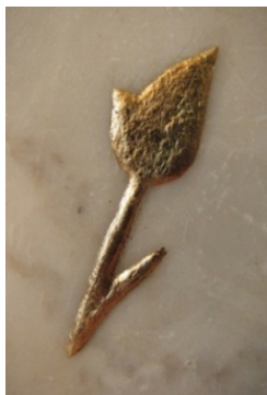
تصویر ۳۰. نمونه اجراشده در یک مرحله برای پیرسازی رطوبتی (نگارندگان).
