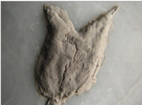
تصویر ۲۱. ترک‌ها بر سطح نقوش اجرا شده با نسبت سربش یک به پانزده (نگارندگان).
