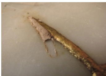
تصویر ۳۴. نمونه اجراشده به روش لایه لایه برای پیرسازی رطوبتی پس از پیرسازی (نگارندگان).
