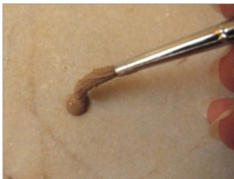
تصویر ۱۳. ترکیب لایه چینی با غلظت مناسب که بر سطح سنگ شره نمی کند (نگارندگان).
