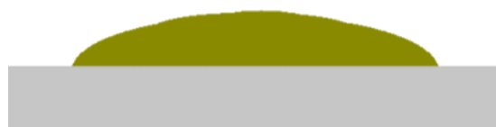
تصویر ۲۷. طرح ترسیمی از مقطع تزئینات مورد بررسی، نمونه لایه چینی روی سنگ در کویش شمس‌العماره (نگارندگان).
