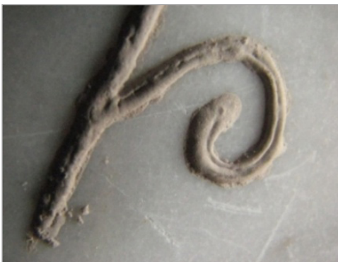
تصویر ۲۲. فرورفتگی‌ها بر سطح نقوش اجرا شده با نسبت سربش یک به پانزده (نگارندگان).
