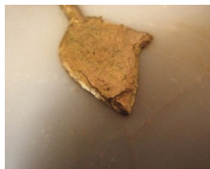
تصویر ۳۳. نمونه اجراشده به روش لایه لایه برای پیرسازی رطوبتی پس از پیرسازی (نگارندگان).
