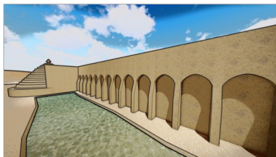
تصویر ۲. تصویر شماتیک دیوار سایه‌انداز و حوضچه‌های یخ‌بند یخچال عباس‌آباد رفسنجان (نگارندگان)
