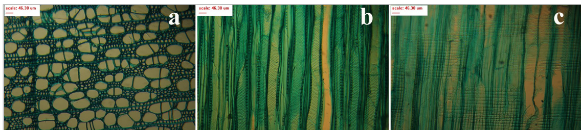
تصویر ۷. مقاطع میکروسکوپی نمونه کاخ شهرستانک کرج: مقاطع عرضی (a)، مماسی (b) و شعاعی (c) (نگارندگان)
